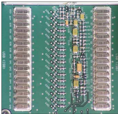
Bild 7: Zwei der drei 16-poligen Quarzfilter des Senders. Das Filter des HF-Prozessors befindet sich auf der Rückseite.
